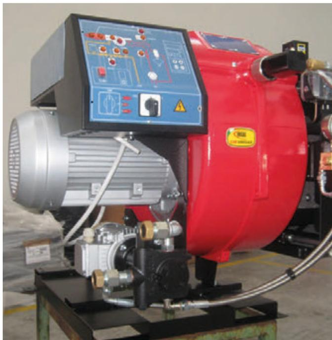
Brenner der Firma CIB UNIGAS mit hp-Brennerpumpe UHE
