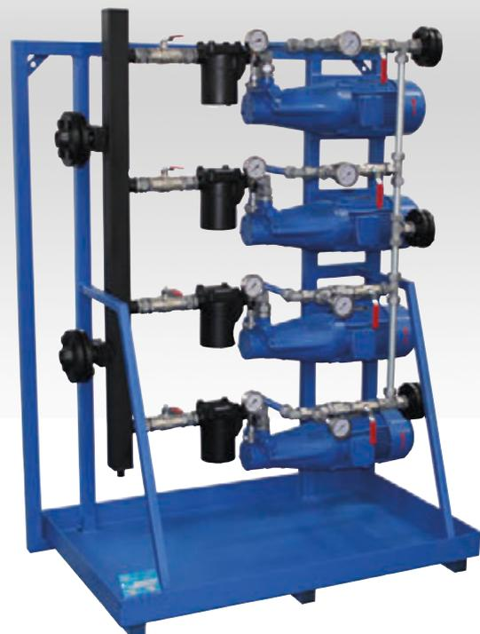
Vierfachaggregat als Zubringeraggregat in vertikaler Ausführung, für Wandmontage
