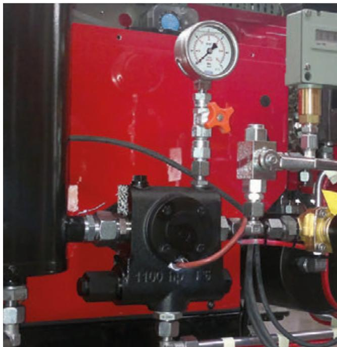
Brenner der Firma Oilon mit hp-Brennerpumpe UHE
