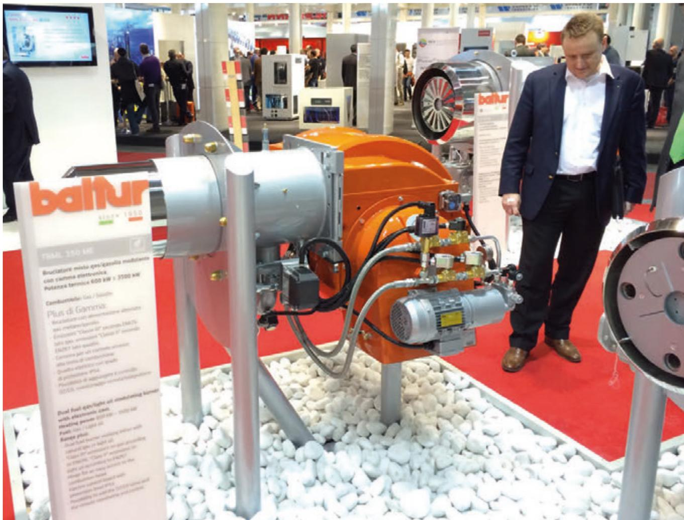
Brenner der Firma Balfur mit hp-Motorpumpengruppe SMG
