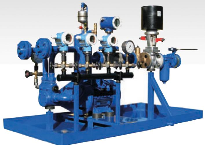
Einzelaggregat als Druckaggregat mit integrierter Entlüftung des Rücklauföls (redundante Meßwert erfassung und Armaturen mit Endlagenschaltern)
