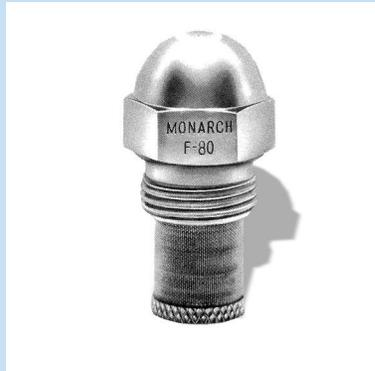
Die Hohlkegelstrahldüse F-80 erzeugt die feinstmögliche Zerstäubung bei Betrieb mit direktem Druck. Weder Luft noch Dampf werden als Zerstäubungsmittel benötigt. Während höherer Druck kleinere Tröpfchen-Größen erzeugt, arbeiten diese Düsen auch mit Wasser bei Druckhöhen von 40 PSI oder mehr. Diese Düsen sind mit einem 9/16" 24 NEF Maschinengewinde ausgestattet, um entweder auf einfachen oder mehrfachen Anschlussstücken montiert zu werden.
